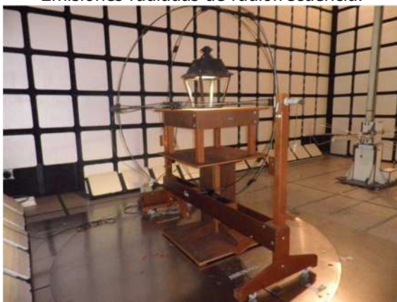
Emisiones radiadas de campo magnético.
