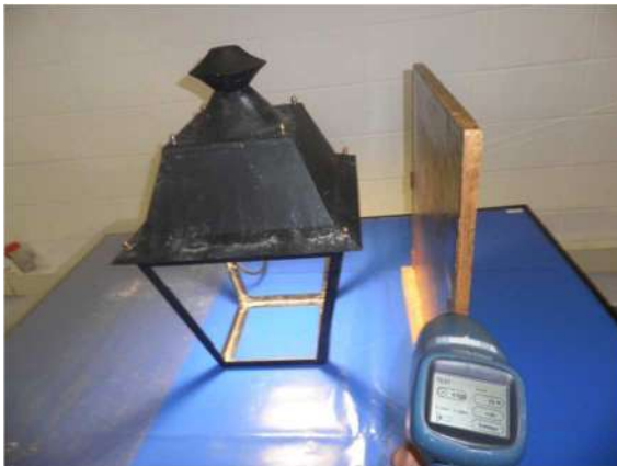
Inmunidad a las descargas electrostática.
